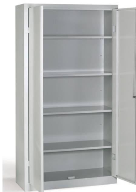
**Armadi PORTA SCOPE** monoblocco costruiti in lamiera d'acciaio di spessore in 6/10 con tutti i bordi raggiungibili ripiegati. Internamente corredati da kit portascoppe costituito da 1 tramezzina verticale e 4 pianetti. Una sola anta e chiusura con serratura a chiave tipo yale, per il modello più piccolo; ante a battente, chiusura con serratura a chiave, tutti con cerniere speciali anti effrazione con rotazione a 180°. Verniciatura a polveri epossipoliesteri di colore grigio.
