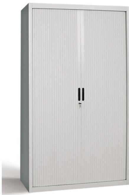
**Armadi** metallici con porte a serranda. Costituiti in lamiera di acciaio spessore 8/10; montaggio degli elementi ad incastro, zoccolo h 60 mm. Verniciatura a polveri termo indurenti di colore grigio. Serrandina di colore grigio a scorrimento orizzontale in materiale plastico a scorrere su apposite guide superiori ed inferiori; maniglie incassate, piani interni regolabili su cremagliera, predisposti per alloggiamento cartelle sospese. Chiusura con serratura a cilindro.
